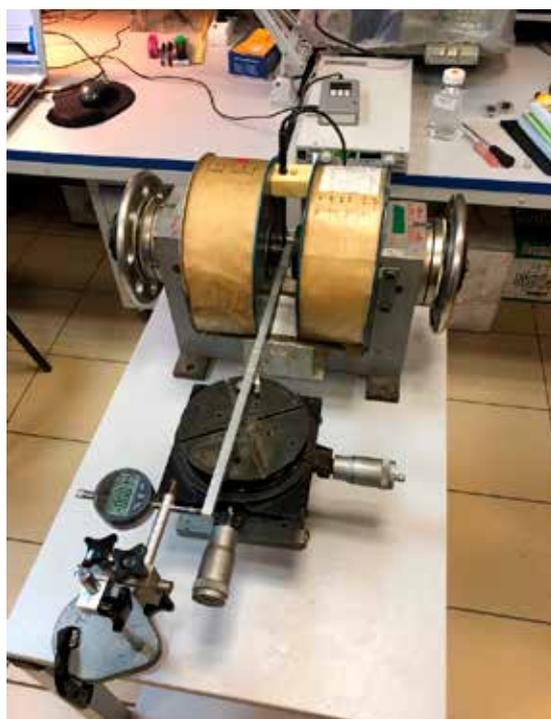
Рис. 3. Внешний вид установки для измерения зависимости магнитоэластики МАЭ от магнитного поля  $H$ .
