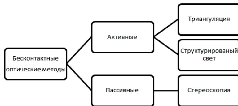
Рис. 11. Бесконтактные оптические методы для получения трехмерных моделей.
