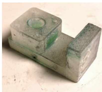
Рис. 12. Общий вид детали после травления.
