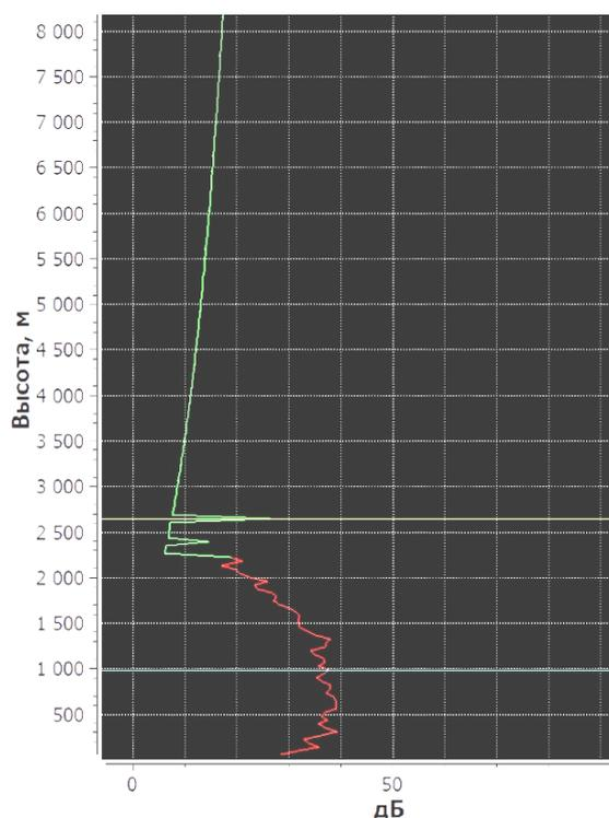
Рис. 4. Зависимость мощности сигнала от высоты зондирования.
