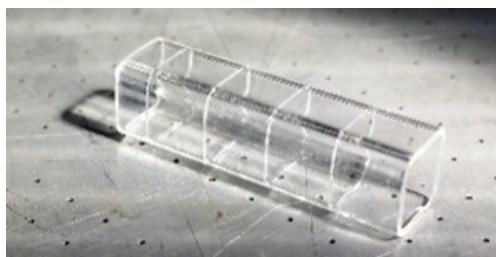
Рис. 13. Отрезок квадратной трубки из стекла Borofloat 33 после резки ЛУТ.
