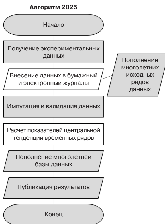
Рис. 2. Модернизированный алгоритм обработки временных рядов данных о концентрациях загрязняющих веществ в атмосферном воздухе (белым выделены шаги алгоритма, подробно рассмотренные в работе)
