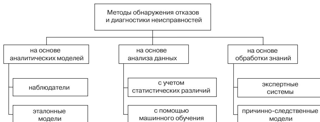
Рис. 3. Классификация методов обнаружения отказов и диагностики неисправностей
