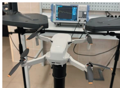
Рис. 1. МРО квадрокоптерного типа при захвате радиоизображения
