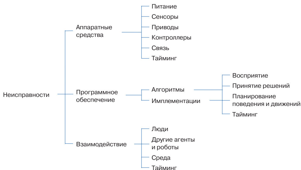
Рис. 2. Классификация неисправностей в робототехнических системах
