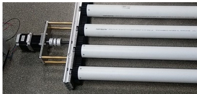
Рис. 5. Крепление двигателя через пластину позволяет адаптировать крепление к любому шагу основных роликов
