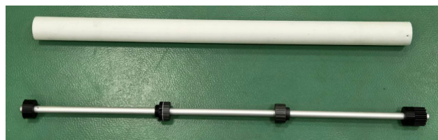
Рис. 3. Вал основного ролика с установленными усилителями, фланцем и шкивом, внешняя труба перед сборкой
