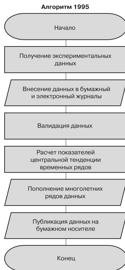
Рис. 1. Существующий алгоритм обработки временных рядов данных о концентрациях загрязняющих веществ в атмосферном воздухе
