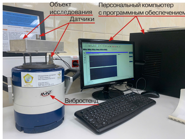
Рис. 14. Лабораторно-экспериментальный комплекс для вибродиагностики конструкции ПУ
