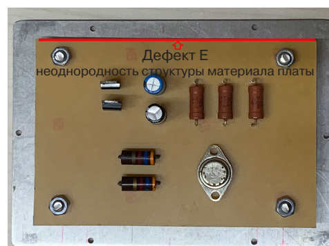
Рис. 25. Отчет о техническом состоянии исследуемого макета с дефектом Е
