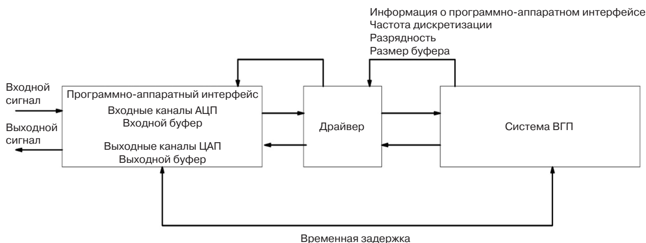
Рис. 1. Функциональная схема реализации метода киберфизической SPICE-эмуляции. Система ВГП – система визуального графического проектирования
