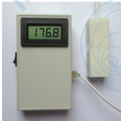
Рис. 11. Макет магнетометра с МЭ-датчиком и его технические характеристики.
