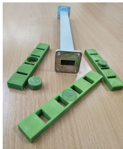
Рис. 2. Общий вид изготовленных фотонных кристаллов с дефектом
