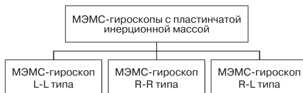
Рис. 5. Типы МЭМС-гироскопов с инерционной массой
