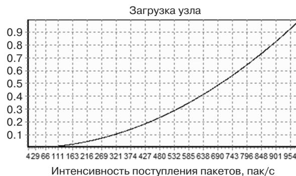
**Рис. 6.** Зависимость загрузки узлов сети от интенсивности поступления пакетов в узлы беспроводной сети при случайном размещении узлов ( $N = 100$ ) и одинаковой интенсивности поступления пакетов в узлы сети
