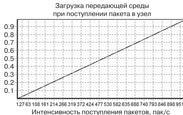
**Рис. 5.** Зависимость загрузки передающей среды при поступлении пакета в узел от интенсивности поступления пакетов в узлы беспроводной сети при случайном размещении узлов ( $N = 100$ ), одинаковой интенсивности поступления пакетов в узлы сети
