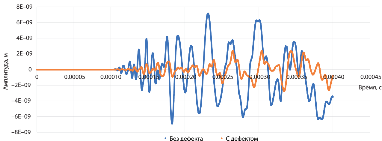
Рис. 8. Сравнение АЭ-сигналов от датчика при наличии и отсутствии дефекта в МПП
