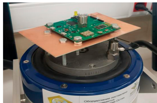
Рис. 4. Установка для проведения экспериментального исследования ПУ при воздействии гармонической вибрации
