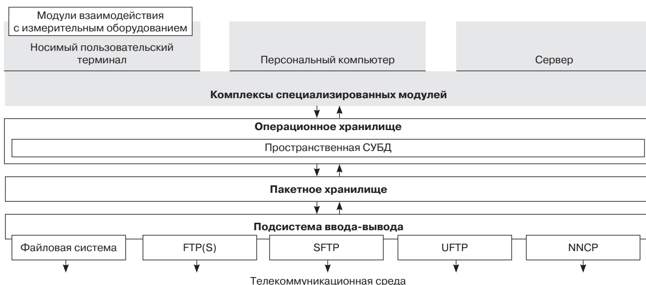
Рис. 1. Принципиальная схема узла распределенной геоинформационной системы. СУБД – система управления базами данных, FTP(S) – file transfer protocol + secure sockets layer
