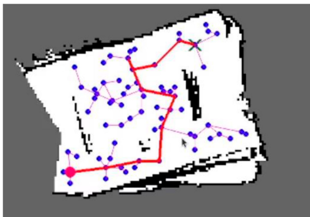
Рис. 5. Использование метода поисковых случайных деревьев RRT для планирования маршрута целенаправленного перемещения автономного мобильного робота на автоматически синтезированной карте
