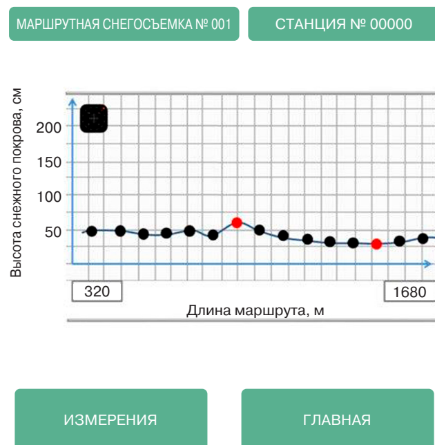
Рис. 2. График маршрута снегосъемки с обозначением пунктов измерений
