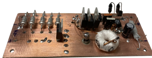
Рис. 6. Собранная плата преобразователя
