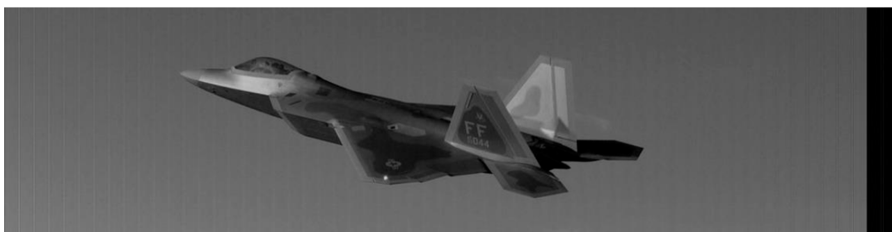
Рис. 10. Смазанное изображение после реставрации обрезанных краев, восстановленное с помощью инверсного фильтра при использовании квадратурной формулы трапеций ( \alpha = 10^{-2} , p = 1 )
