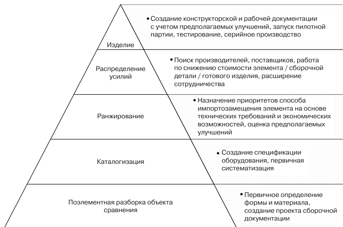
Рис. 5. Иерархическая схема реверс-инжиниринга
