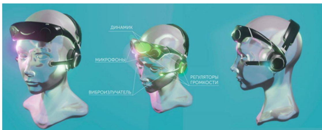
Рис. 7. Концепция бионического шлемофона для людей с ограниченными возможностями
