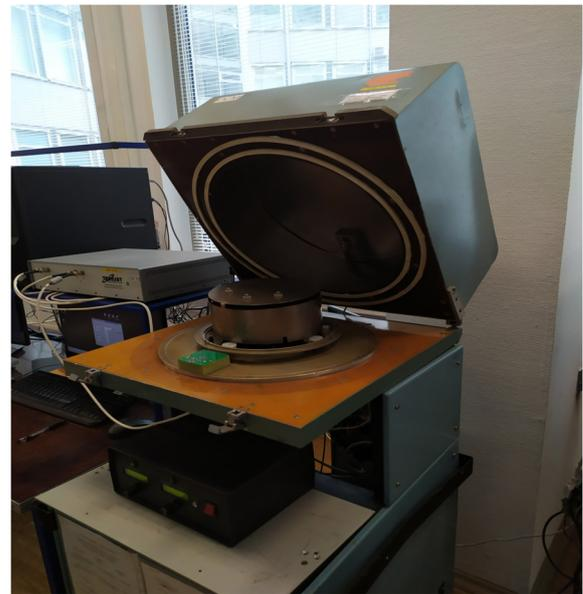
Рис. 2. Термостатирующая частотоизмеряющая установка «Динар»
