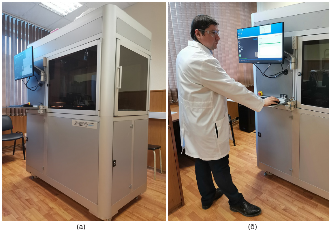
Рис. 1. 3D-принтер DragonFly LDM 2020 мегалаборатории 3D-прототипирования и контроля многослойных печатных плат: установка DragonFly LDM 2020 (а); демонстрация технологии 3D-печати на установке DragonFly LDM 2020 (б)
