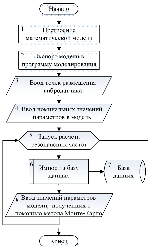
Рис. 5. Блок-схема алгоритма формирования интервалов резонансных частот с учетом внесенных дефектов
