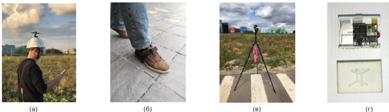
Рис. 3. Визуальное пояснение расположения оборудования: (а) экспериментатор, оснащенный закрепленной на шлеме антенной GNSS приемника, смартфоном для записи данных и двумя ИИБ на ногах (за пределами кадра); (б) ИИБ, прикрепленный на ногу экспериментатора; (в) базовая станция GNSS для получения референсного RTK-решения; (г) ИИБ MIMU22BLPX крупным планом
