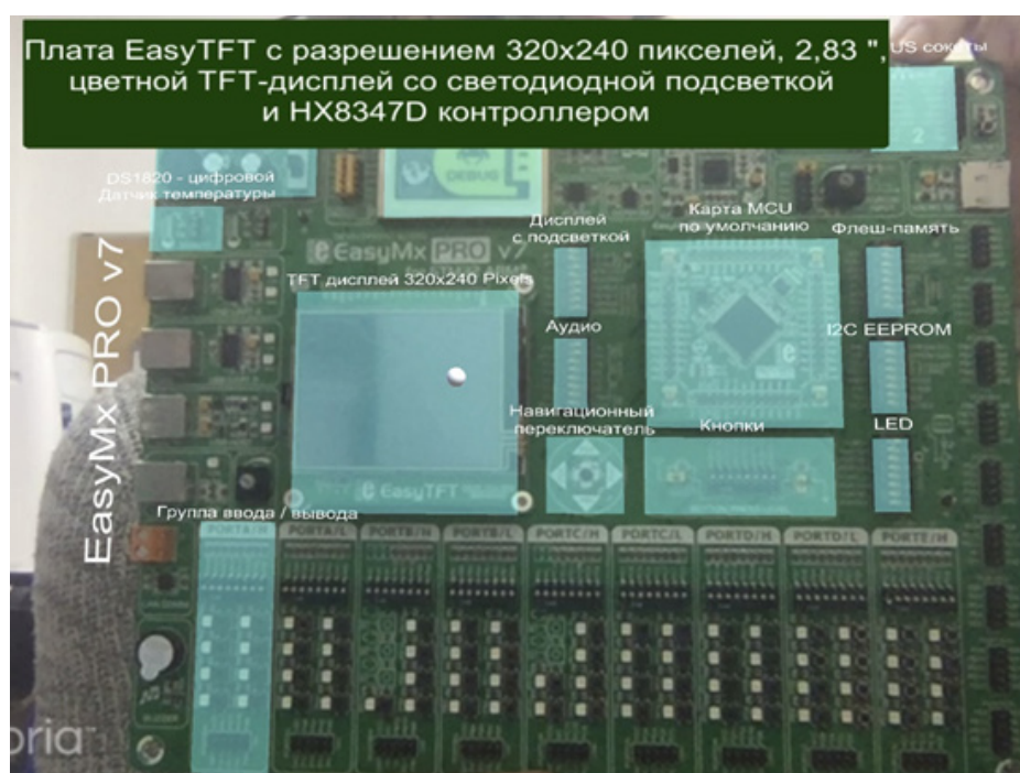
Рис. 3. Пример визуализации элементов содержания технической документации как интерактивного справочного контента поверх отладочной платы.
