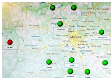
Рис. 9. Визуализация аварийного события на компьютере диспетчера: общая мнемосхема производства с аварийным сигналом протечки в зоне насоса ВН1 (а); вид мнемосхемы с аварийным сигналом на карте размещения производств в городах центрального региона страны (б).
