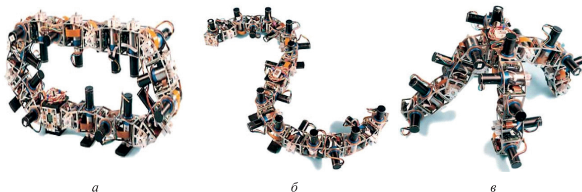
Рис. 1. Примеры различных конфигураций экспериментального образца многозвенного мехатронно-модульного робота с адаптивной кинематической структурой PolyBot (PARK, Xerox, USA): а – конфигурация типа «колесо»; б – змеевидная конфигурация; в – конфигурация шагающей платформы.
