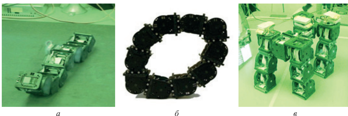
Рис. 2. Примеры различных конфигураций экспериментального образца многозвенного мехатронно-модульного робота с адаптивной кинематической структурой SckBot (Modlab, UPenn, USA): а – змеевидная конфигурация; б – конфигурация типа «колесо»; в – конфигурация шагающей платформы.
