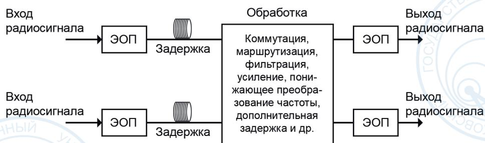
Рис. 6. Радиофотонный принцип построения РЭС.
