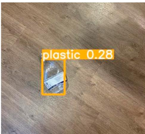
Рис. 2. Результат работы детектора YOLOv4
