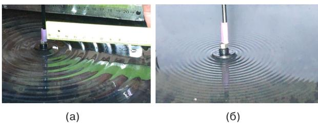
**Рис. 2.** Изображение поверхностных волн при частоте генерации  $f = 16$  Гц (а) и при частоте генерации  $f = 60$  Гц (б)
