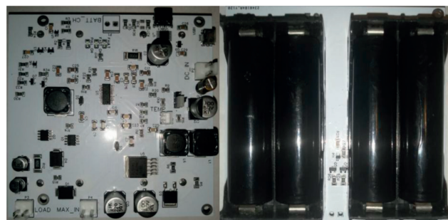
Рис. 13. Прототип блока зарядки и защиты АКБ: вид сверху и снизу
