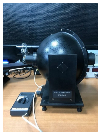
Рис. 8. Общий вид интегрирующей сферы
