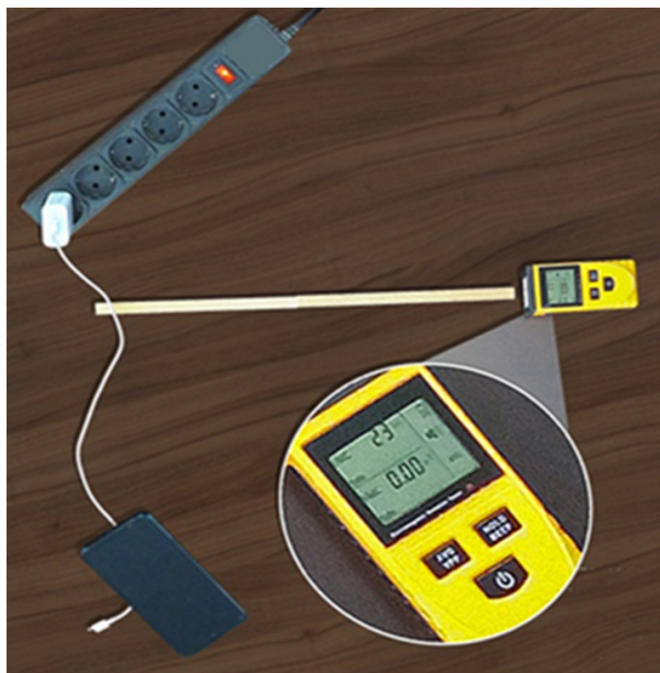
Рис. 2. Индукция ЭП 23 В/м на расстоянии ~0.5 м от шнура, включенного в сеть ~220 В адаптера
