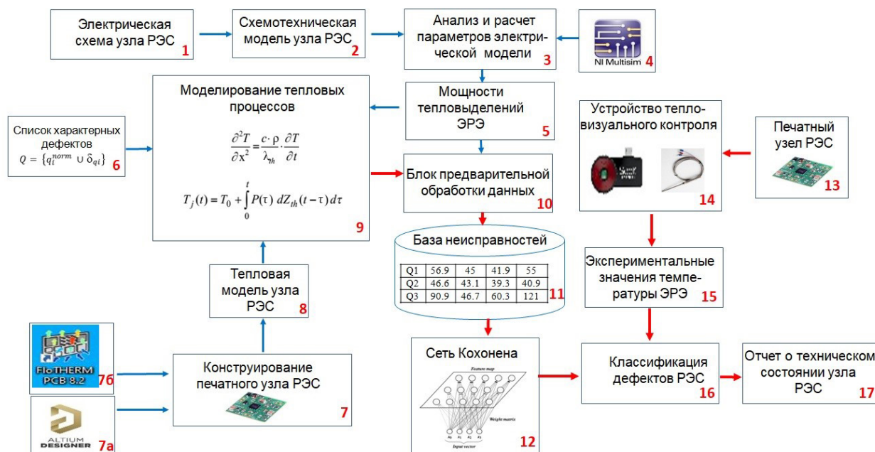
Рис. 1. Структурная схема классификации дефектов печатных узлов с применением сети Кохонена
