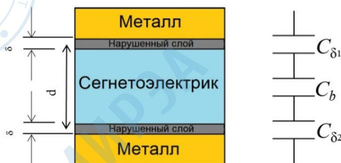
Рис. 1. Нарушенные слои в конденсаторной сегнетоэлектрической структуре.
