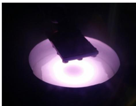
Рис. 4. Напыление AlN в ВЧ разряде.
