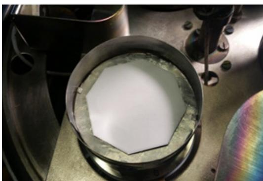
Рис. 3. ВЧ магнетрон с мишенью из нитрида алюминия.
