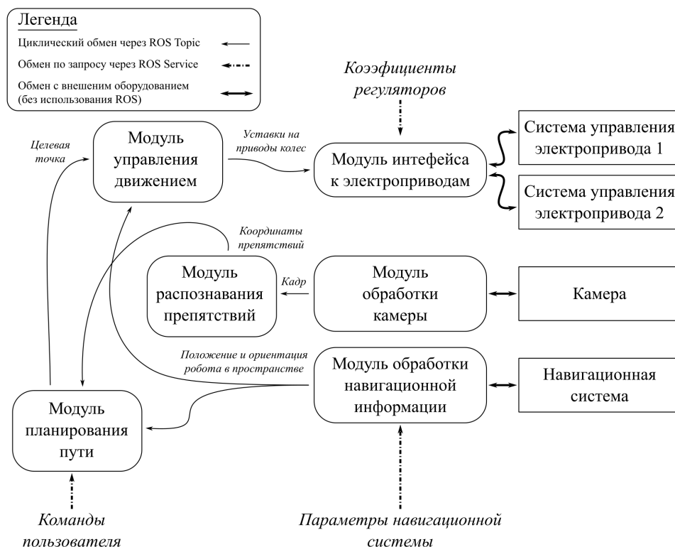
Рис. 1. Пример структуры системы управления мобильного сервисного робота на базе ROS.
