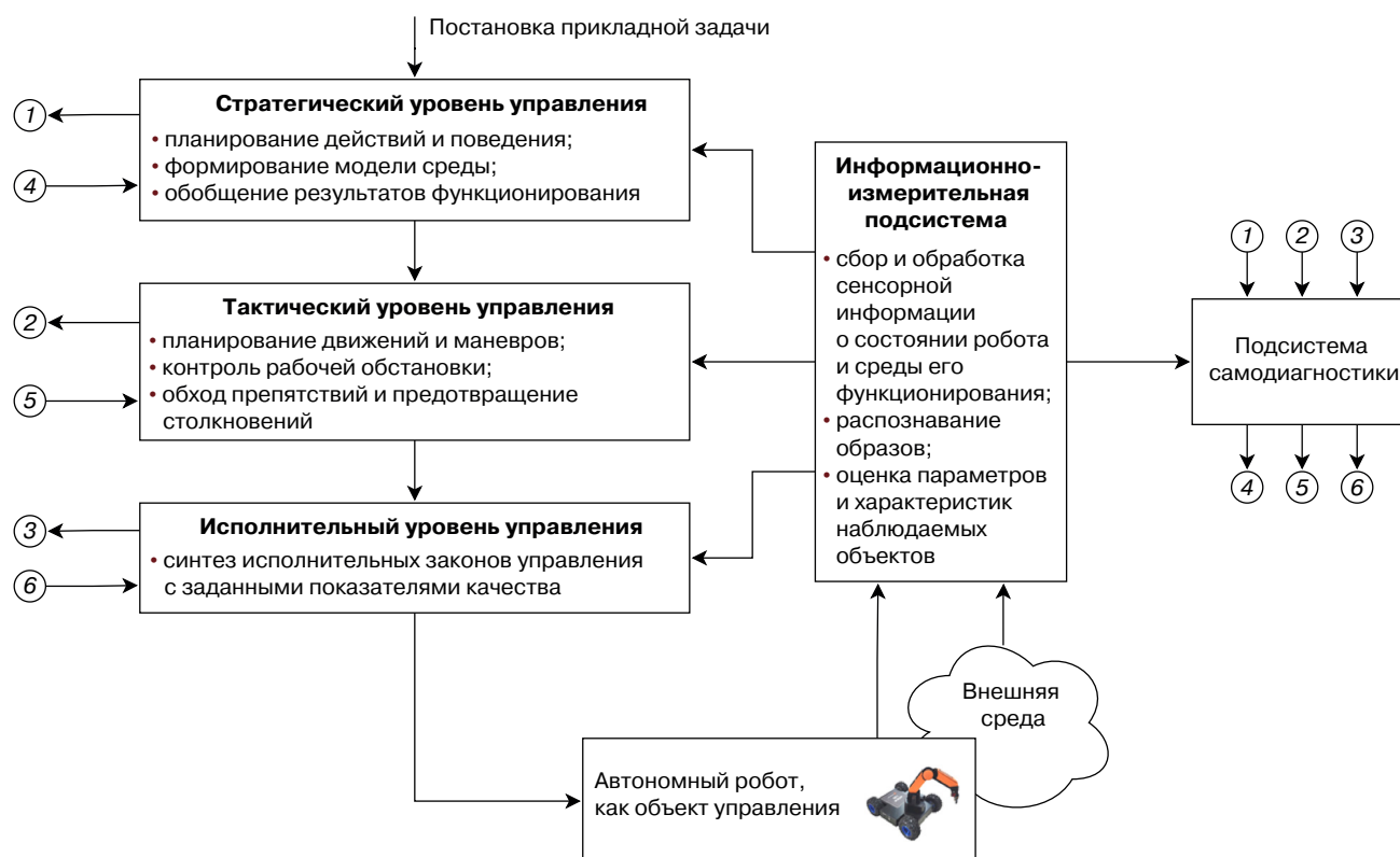
Рис. 1. Обобщенная структура интеллектуальной системы управления автономного робота.
