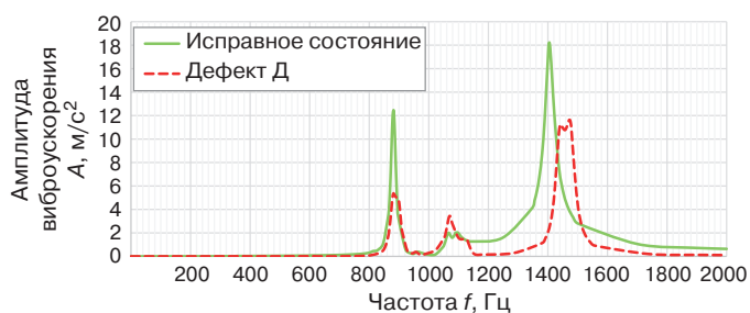
Рис. 10. АЧХ исследуемого макета с дефектом Д
