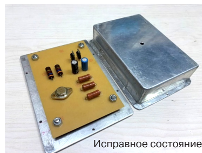
Рис. 13. Конструкция исследуемого макета блока
