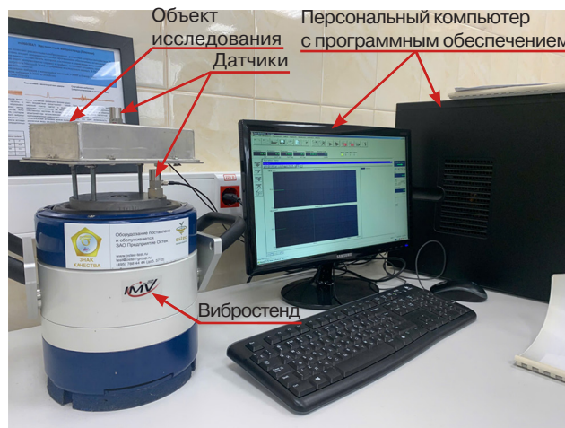
Рис. 14. Лабораторно-экспериментальный комплекс для вибродиагностики конструкции ПУ
