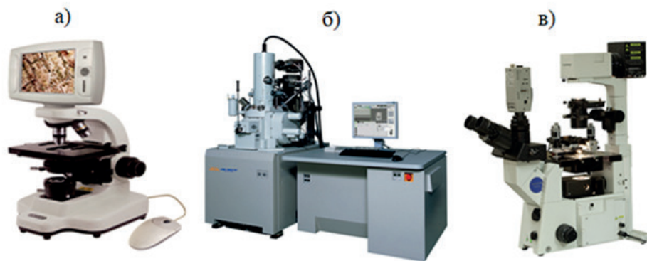
Рис. 10. Установки микровизионной, растрово-электронной и атомно-силовой микроскопии: микровизоры \mu Vizo-101 (а); электронные микроскопы типа JEOL JIB-4601F (б); зондооптический микроскоп Certus Optic U (в).
