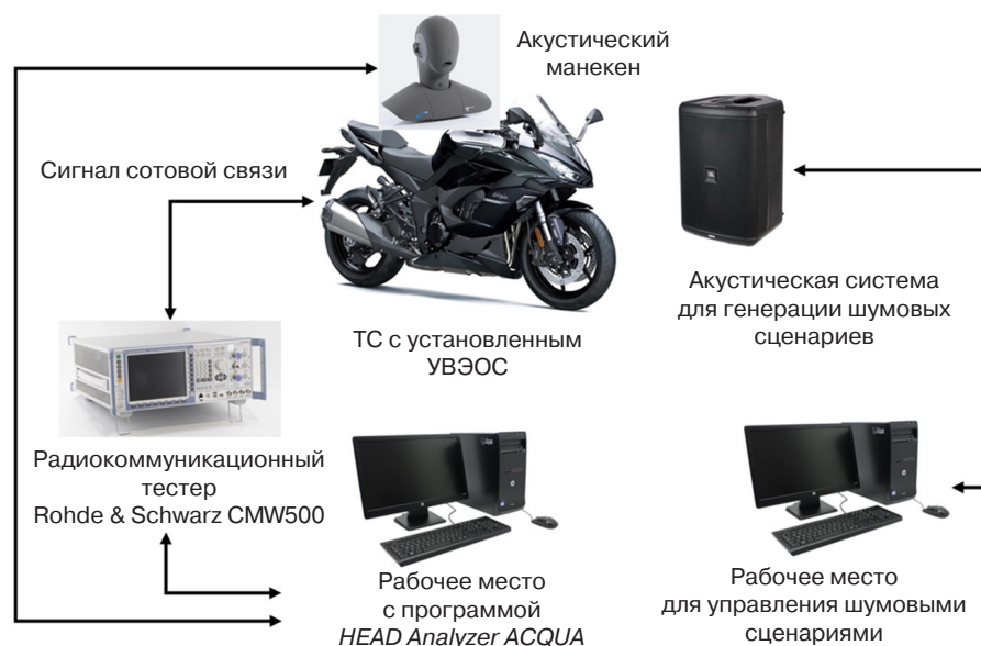
Рис. 7. Структурная схема тестового стенда УВЭОС
