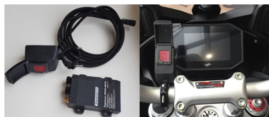
Рис. 4. Размещение УВЭОС на двухколесном ТС
