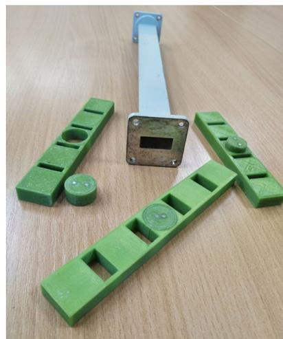
Рис. 2. Общий вид изготовленных фотонных кристаллов с дефектом
