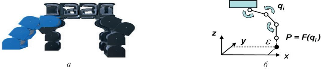
Рис. 9. Оценка соответствия текущей конфигурации конечности (а) состоянию опоры (б).
