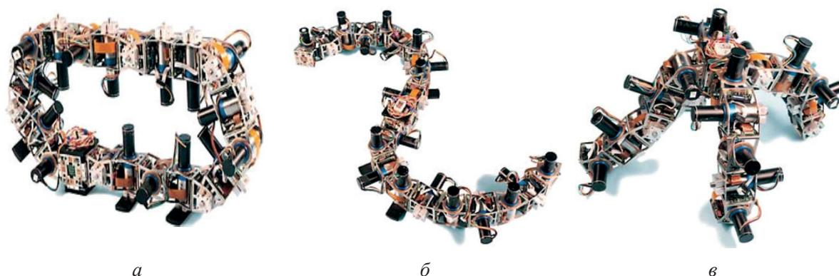
**Рис. 1.** Примеры различных конфигураций экспериментального образца многозвенного мехатронно-модульного робота с адаптивной кинематической структурой PolyBot (PARK, Xerox, USA):
