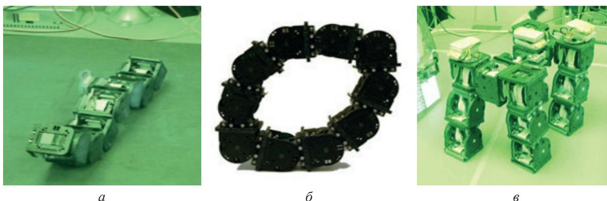
**Рис. 2.** Примеры различных конфигураций экспериментального образца многозвенного мехатронно-модульного робота с адаптивной кинематической структурой SkBot (Modlab, UPenn, USA): *a* – змеевидная конфигурация; *б* – конфигурация типа «колесо»; *в* – конфигурация шагающей платформы.
